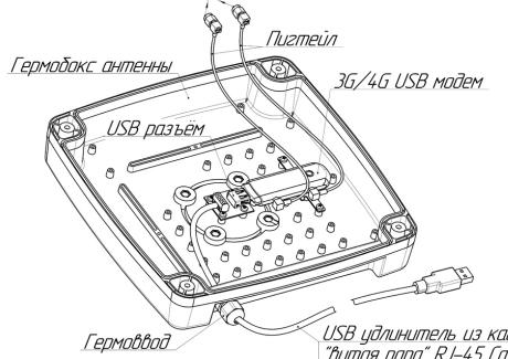
5.4. Подключите USB-модем к USB-разъему на плате. Для более надежной фиксации USB-модема рекомендуем закрепить модем на металлическом кронштейне, например, кабельной стяжкой.
