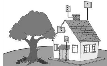
Рисунок 1 – Варианты установки антенны
